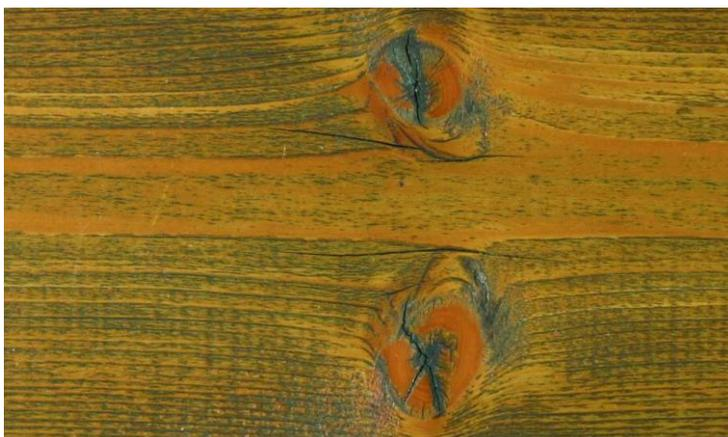
**Degré de dégradation par les intempéries 3**
