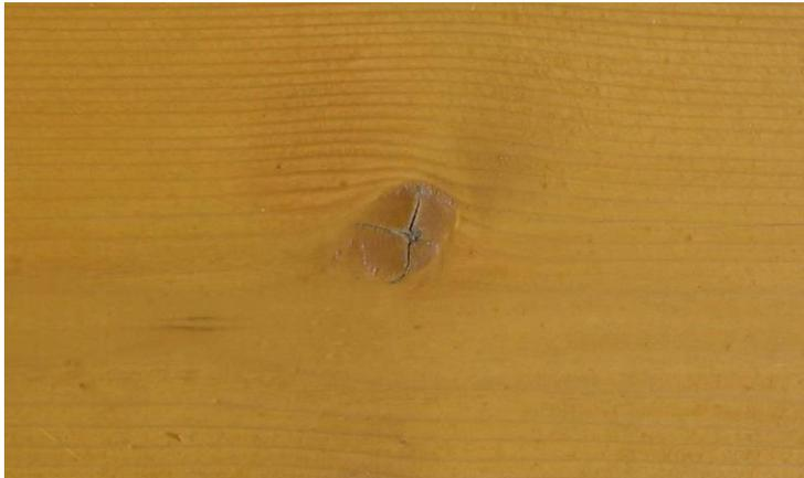
**Degré de dégradation par les intempéries 1**
