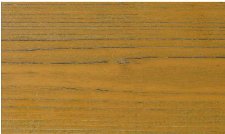
**Degré de dégradation par les intempéries 2**
